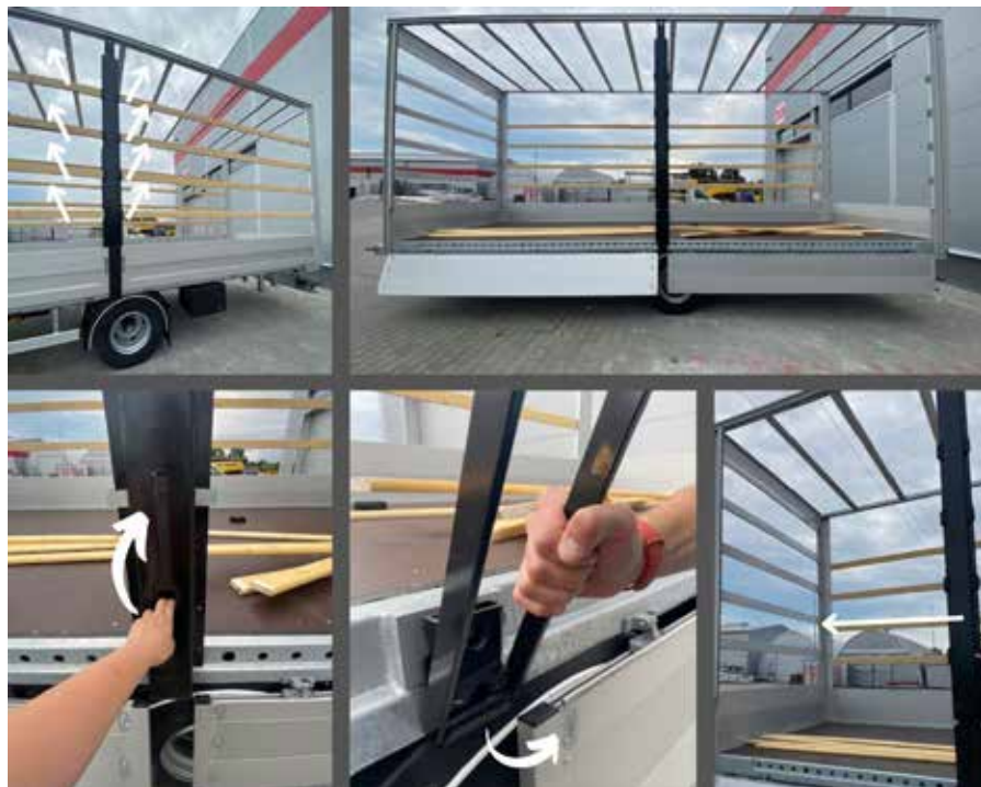
Obrázek 9 Částečné odejmutí sloupku ADEICO
