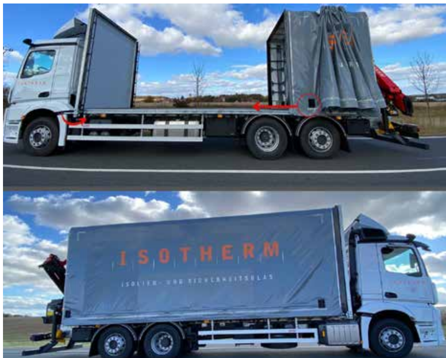
Obrázek 25 zavírání shrnovacího mechanismu plachty DBV
