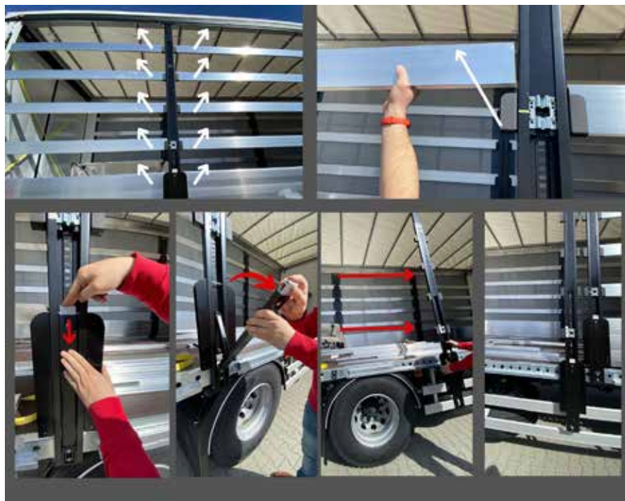
Obrázek 8 Částečné odejmutí sloupku HESTAL
