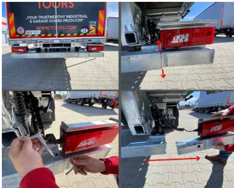
Obrázek 4 manipulace s nosičem motorového vozíku
