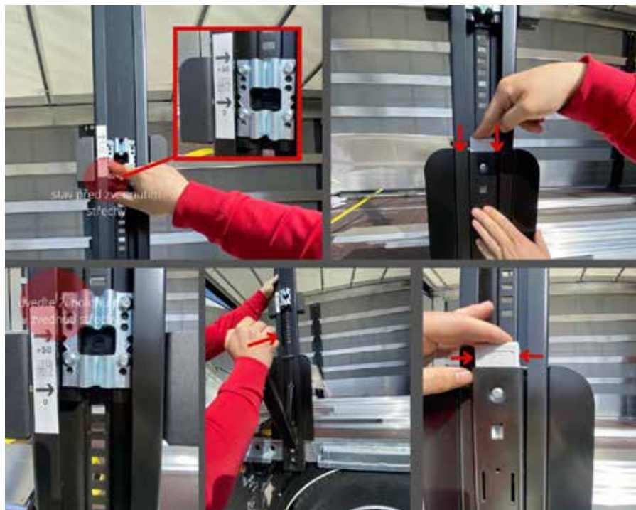
Obrázek 17 Zvedání střechy na středových sloupcích - dvoustavová střešní konstrukce
