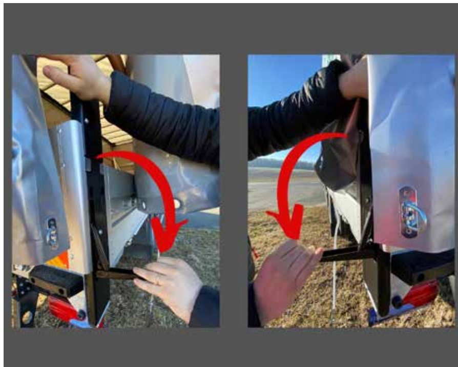
Obrázek 12 Odklopení zadního čela nástavby směrem dolů
