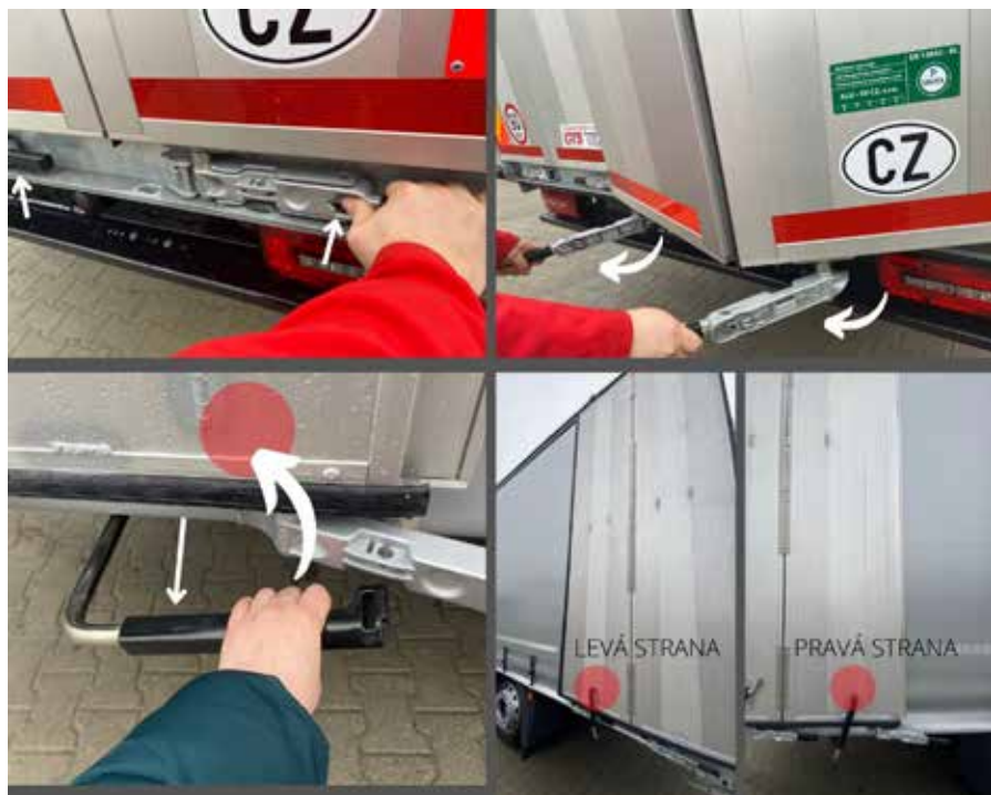
Obrázek 10 Aretování dvoukřídlových/čtyřkřídlových vrat - vnější stranou
