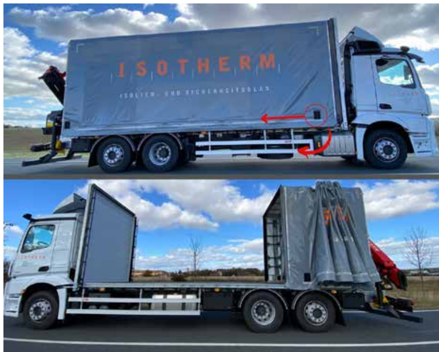
Obrázek 24 Otevírání shrnovacího mechanismu plachty DBV
