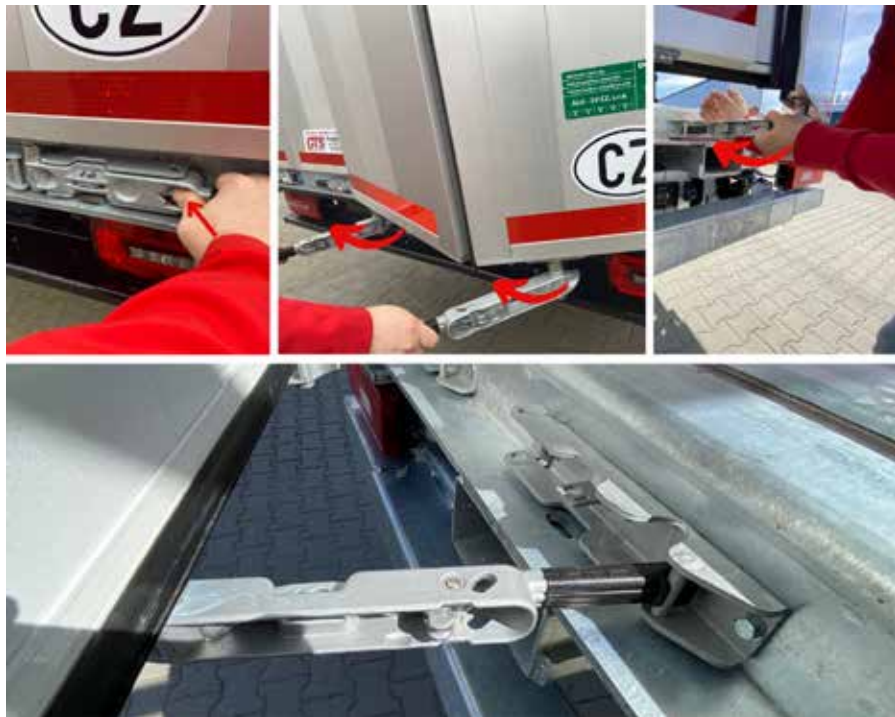
Obrázek 11 Aretování dvoukřídlových/čtyřkřídlových vrat - vnitřní stranou
